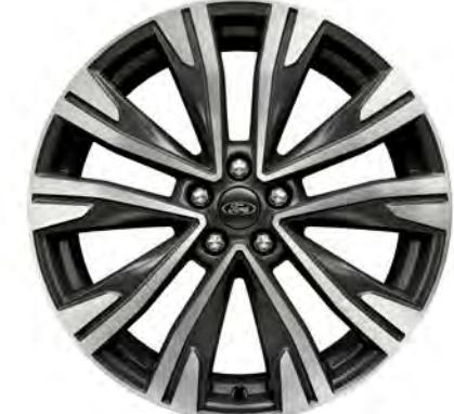
20" Leichtmetallräder 8 J x 20 mit 245/45 R20 Reifen im 10-Speichen-Design in Pearl Grey Premiumlackierung, glanzgedreht Wunschausstattung bei Titanium X, ST-Line X und Vignale
